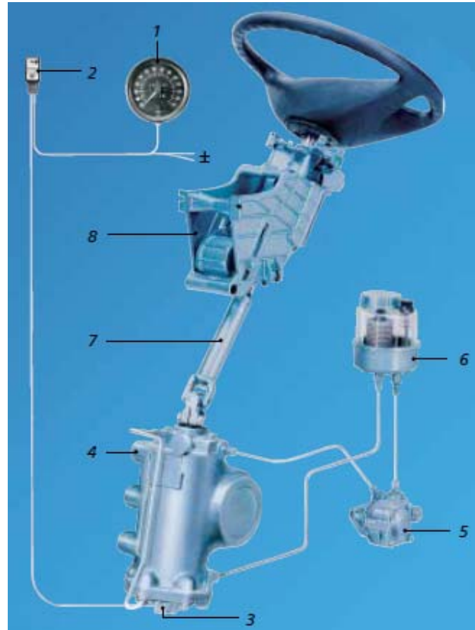
Bild 6: Schematische Darstellung der ZF-Servocomtronic, Typ 8098.
